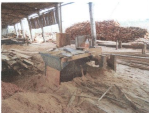
Fotos de máquinas e instalações sem sinalização, existente no local
