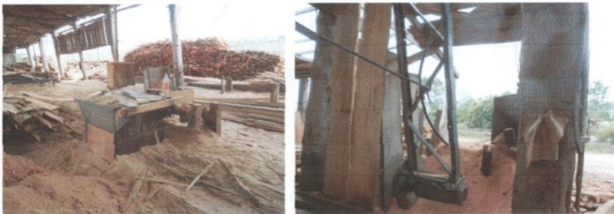
Fotos de maquinas sem dispositivo de proteção existente no local
