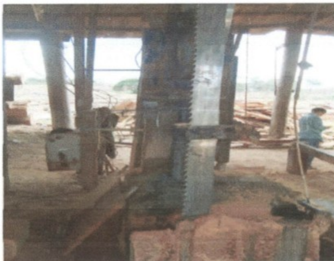
Foto da maquina serra fita sem proteção existente no local
