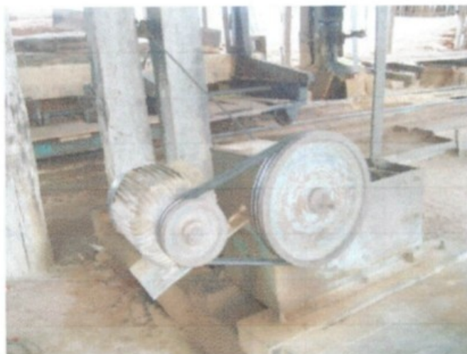
Transmissão de força de uma das máquinas sem proteção existente no local
