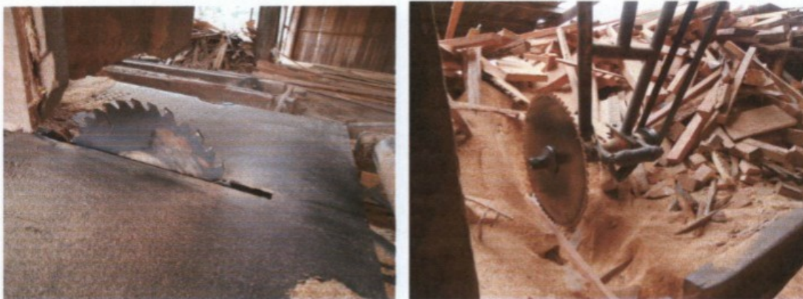
Zonas de perigo das máquinas sem proteção e dispositivos de segurança interligados.
