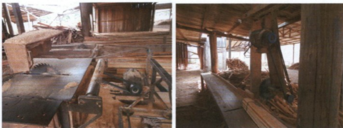
Máquinas sem proteção fixas ou móveis.
