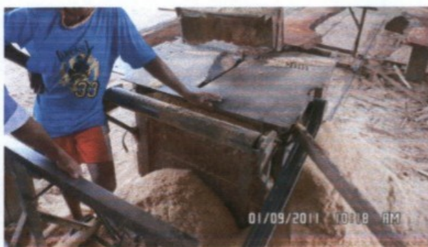
Máquinas e instalações sem sinalização de segurança
