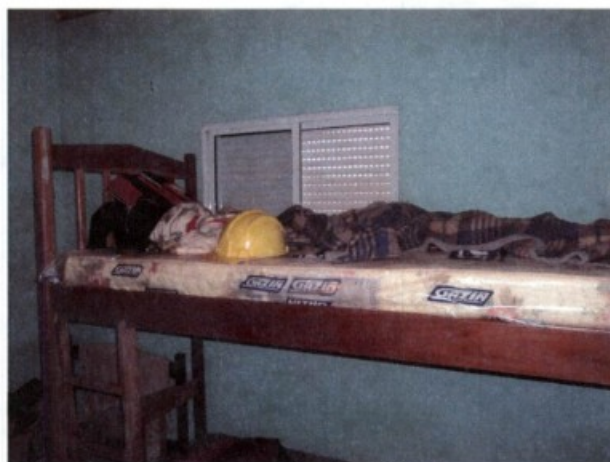
Beliches instalados na frente das janelas, obstruindo a entrada e saída de ar.
