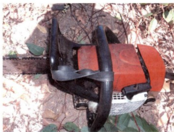
O freio manual amarrado com uma borracha.
