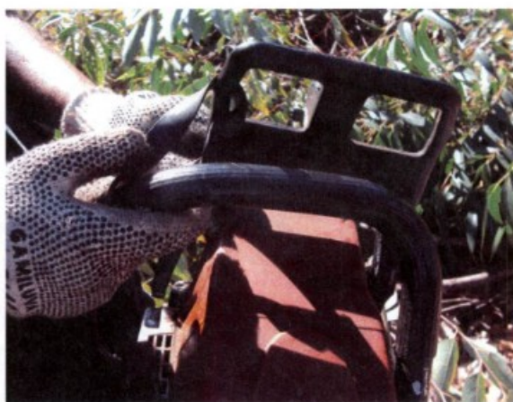
O freio manual amarrado com uma borracha.
