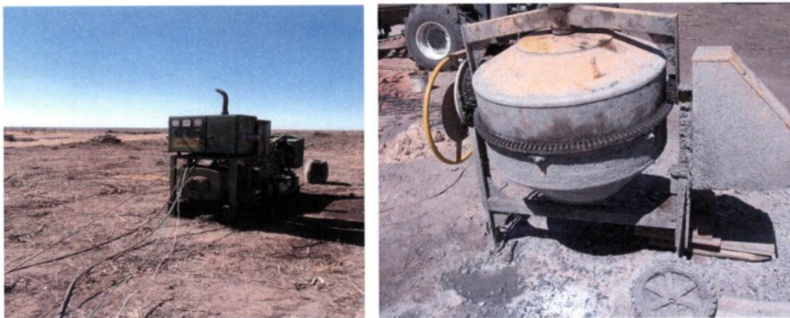
Equipamentos sem aterramento.
