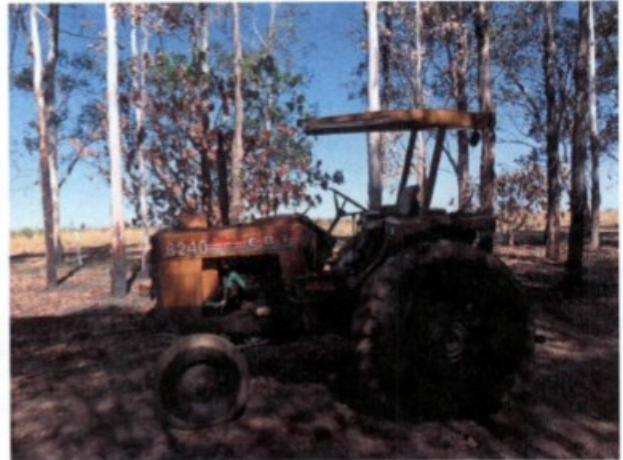
Ausência de luzes e sinais sonoros de ré acoplados ao sistema de câmbio.
