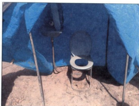
Instalação sanitária improvisada, instalada distante do local de trabalho e sem atender as especificações técnicas da NR 31.
