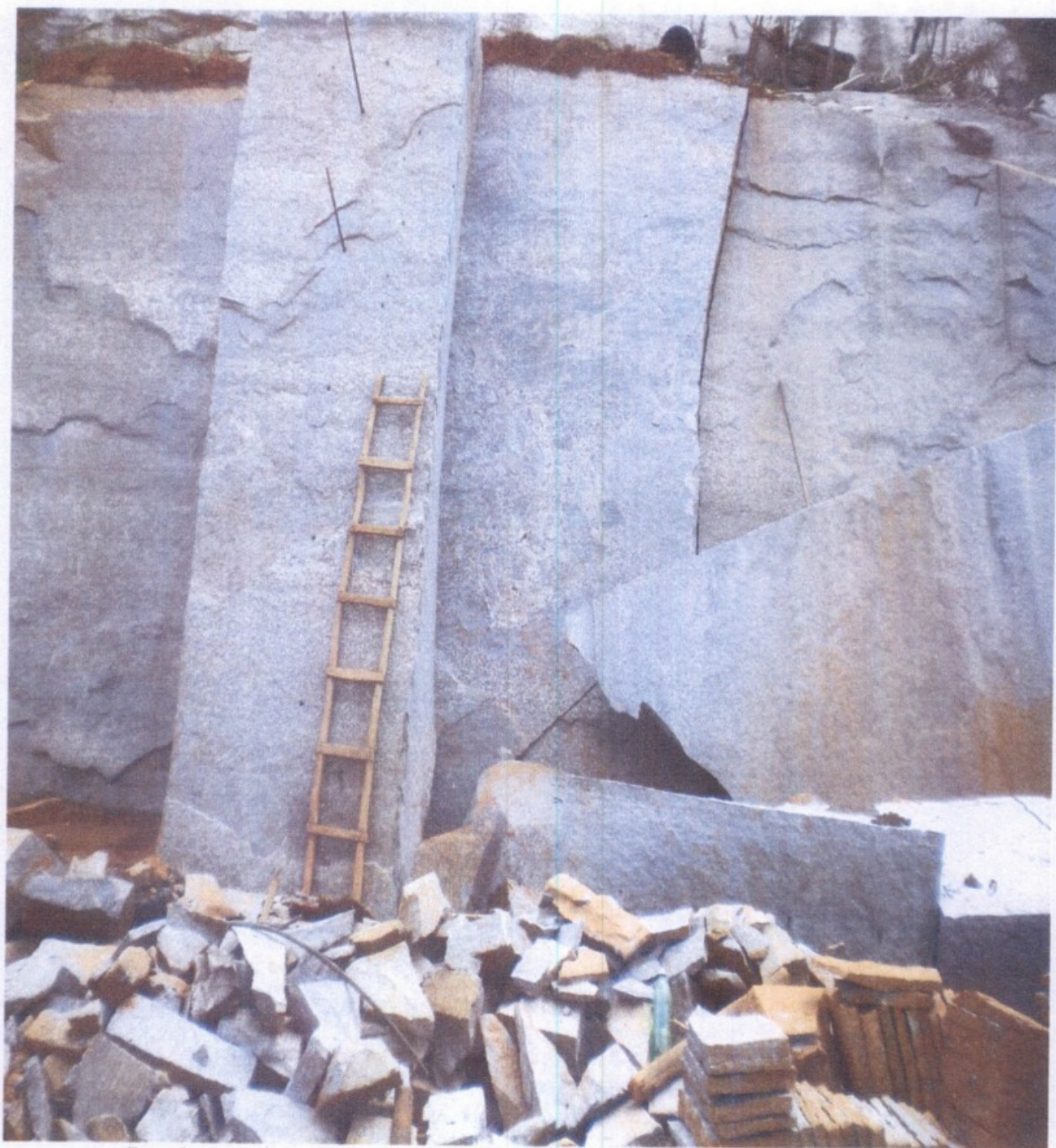
Escadas precárias utilizadas pelos empregados na área da extração de pedras
