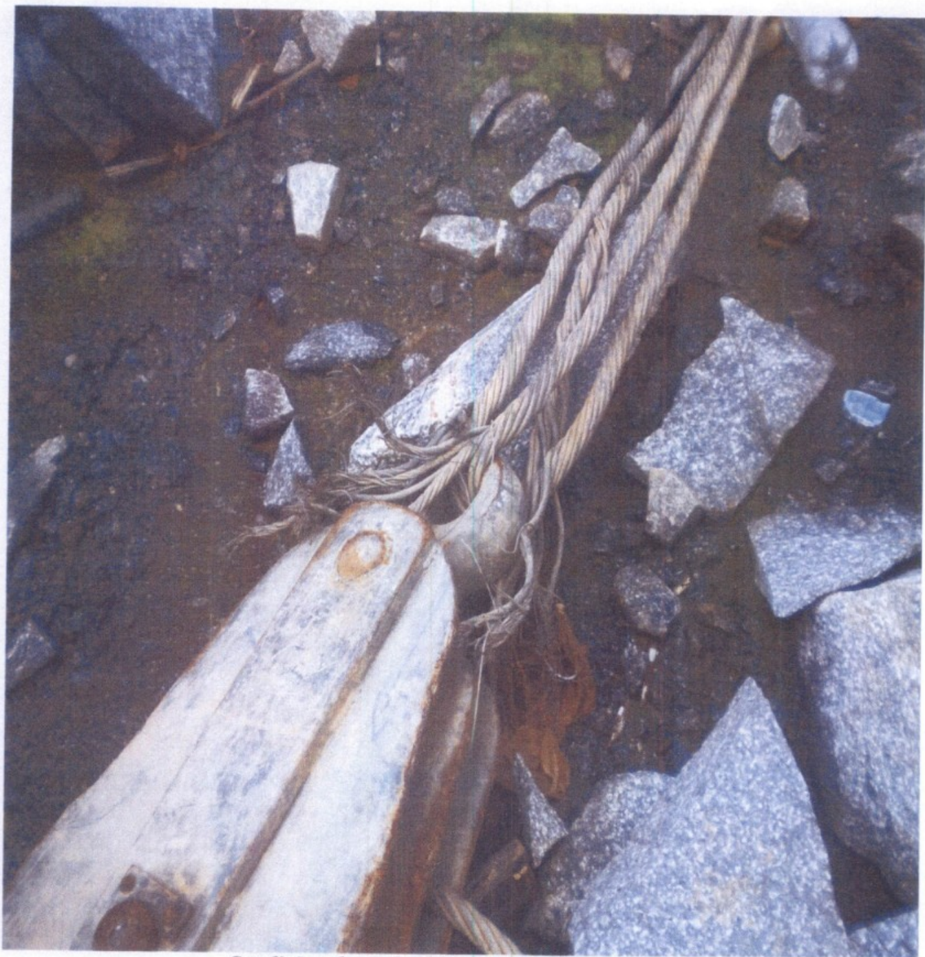
Condições dos cabos de sustentação do pau de carga
