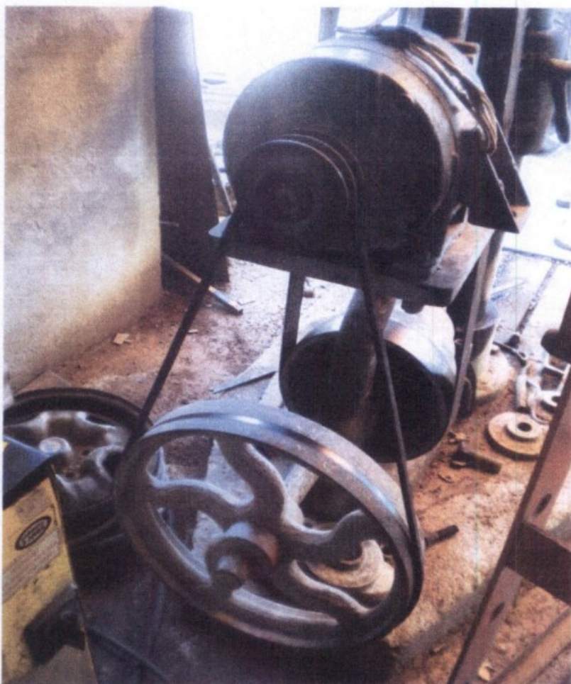
Maquinário sem proteção das correias o que oferece riscos para o trabalhador - interdita pela fiscalização
