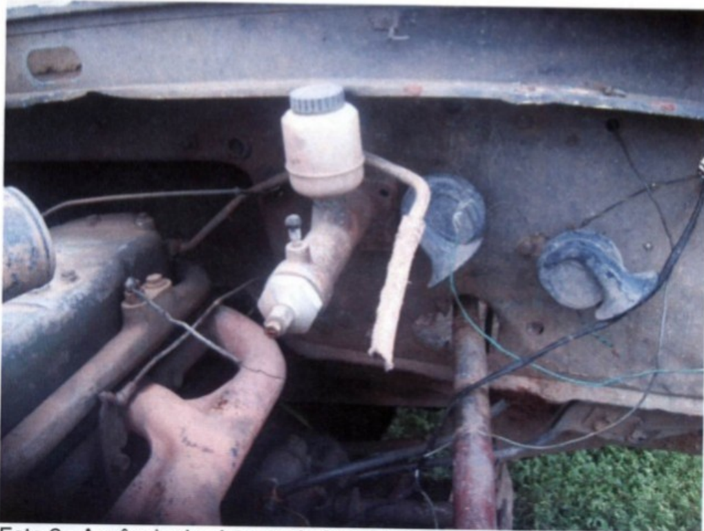
Foto 2 - Ausência de sistema de frenagem no caminhão.
