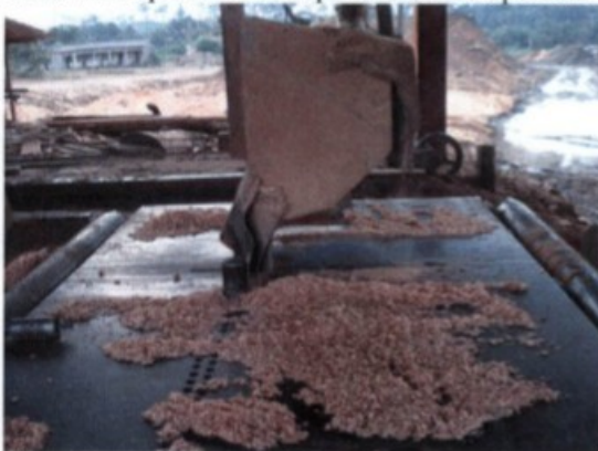
Área de corte desprotegida na alinhadeira.
