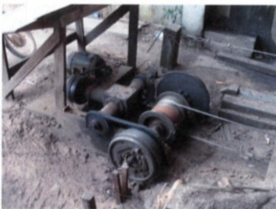
Transmissões de força desprotegidas no avanço da plataforma que guia a tora para a Serra-fita.
