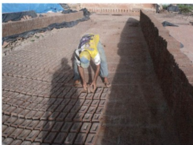
Fotos 10 e 11: Tijolos sendo moldurados manualmente e colocados para secar à luz do sol
