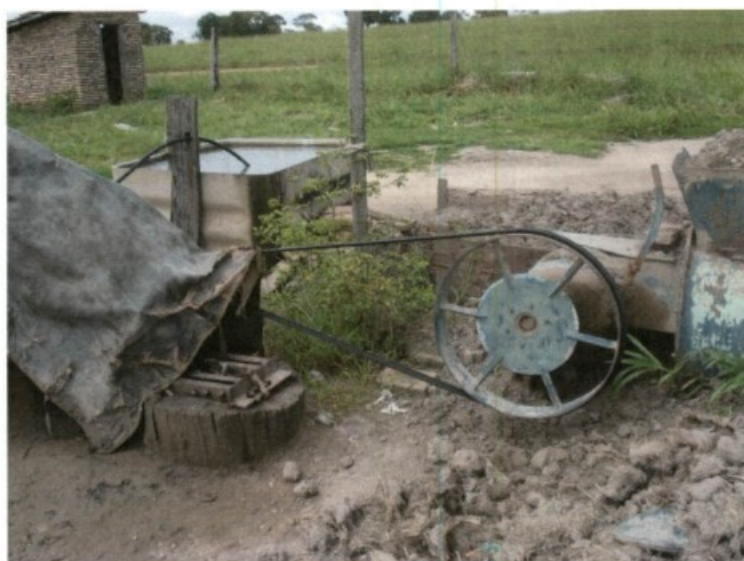
Foto 26: maromba usada no preparo da argila com partes móveis (correias) expostas.
