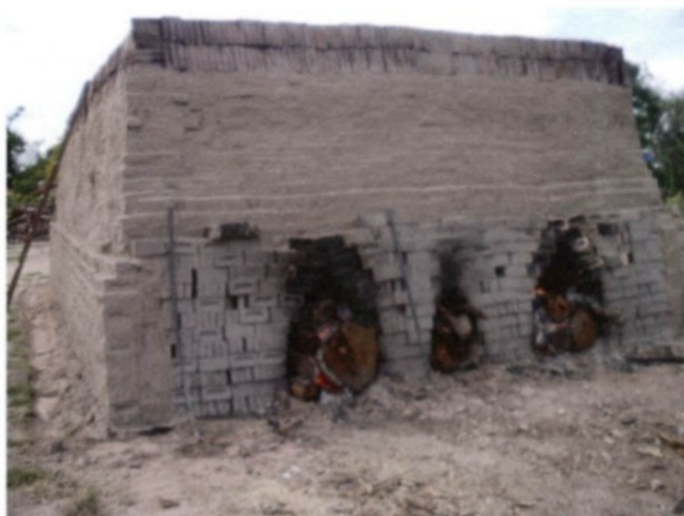
Foto 01 –Tijolos em processo de queima.
