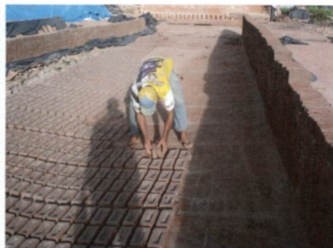
Fotos 08 e 09: Tijolos sendo moldurados manualmente e colocados para secar à luz do sol
