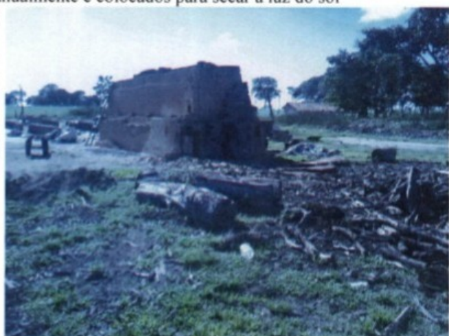
Fotos 10 e 11: Tijolos empilhados, formando caieiras com 100 mil unidades, e tijolos já em processo de queima.
