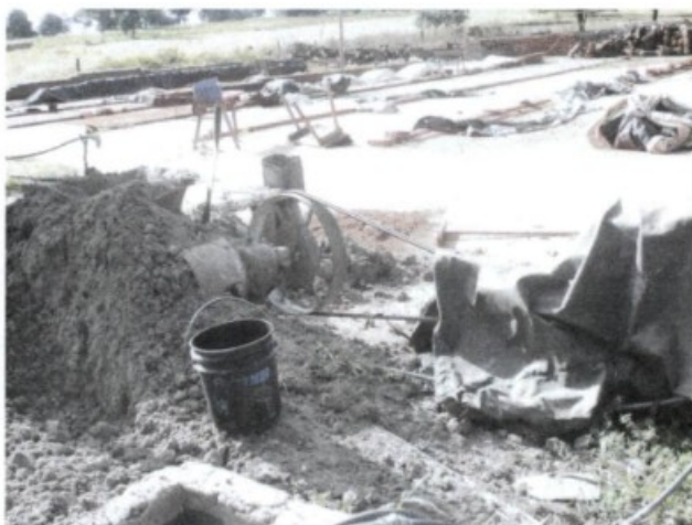
Fotos 48 e 49: máquinas (maromba) com partes móveis expostas.
