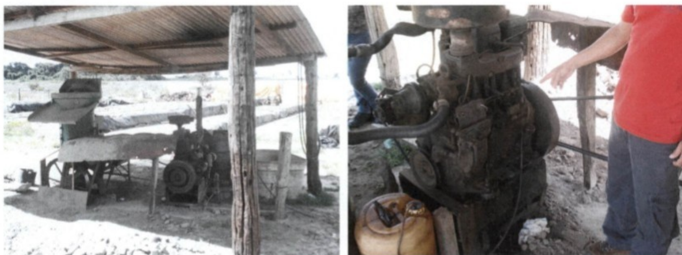
Fotos 30 e 31 – Máquinas (maromba) sem proteção das partes móveis (correias).
