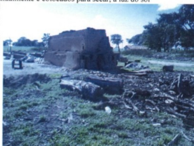
Fotos 12 e 13: Tijolos sendo empilhados, formando caieiras com 100 mil unidades, e tijolos já em processo de queima.
