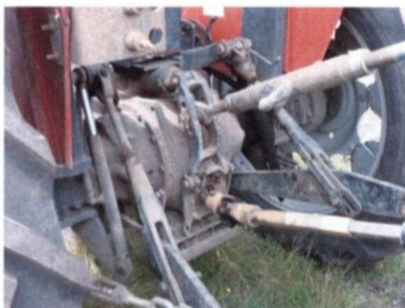
Tratores com transmissão de força desprotegidos.
