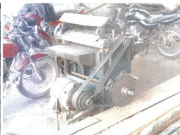
Fotos 02 e 03 – Serra circular e correias de motor sem proteção de suas partes móveis.
