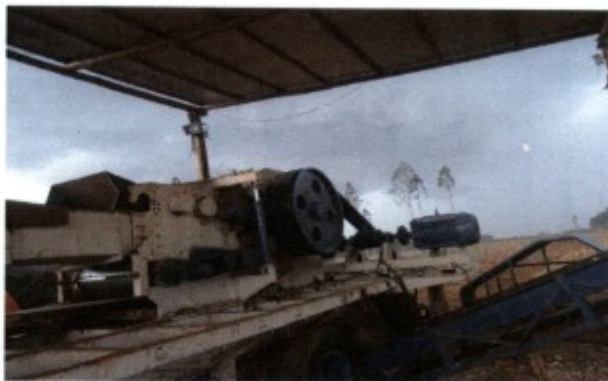
Equipamento Industrial Móvel, utilizado para picar madeira, fabricar Cavacos. ( EQUIPAMENTO PERTENCENTE A EMPRESA BIOMAS).
