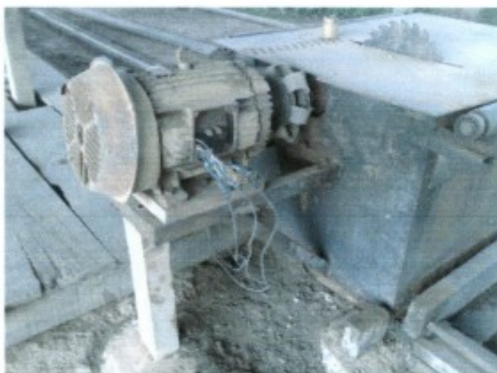
Máquinas com fiação exposta. Serra sem proteção
