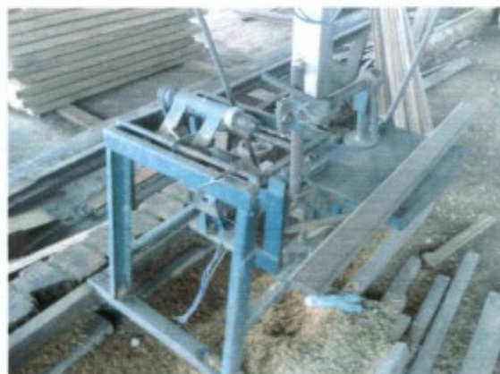
Máquinas com fiação exposta. Serra sem proteção
