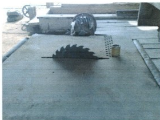
Máquinas com fiação exposta. Serra sem proteção
