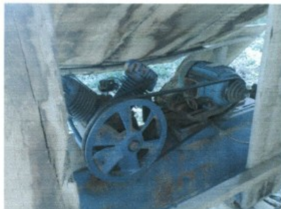
Condições elétricas irregulares. Correias sem proteção
