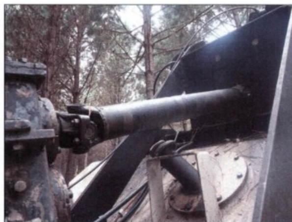
Detalhe do eixo cardan desprotegido.
