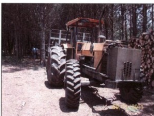
Trator sem buzina, sem cinto de segurança, sem espelho retrovisor, sem luz e sinal sonoro de ré.
