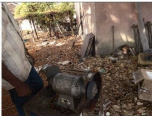
Máquina desprotegida (esmeril)
