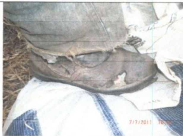
Botina de segurança adquirida pelo trabalhador e em péssimas condições de uso
