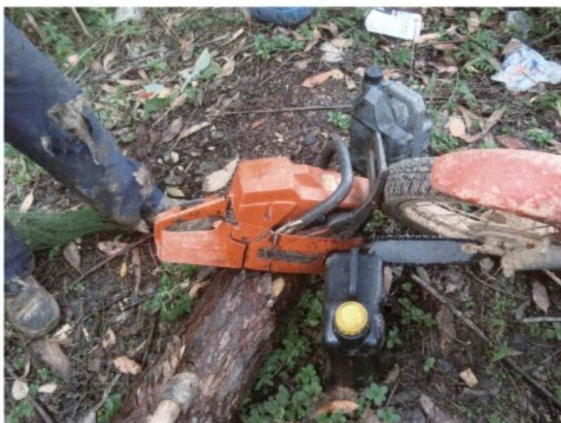
Motosserra do trabalhador, sem os itens obrigatórios de segurança.
