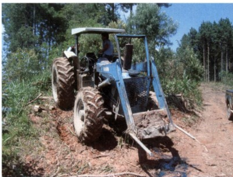
Trator sendo utilizado na frente de trabalho, sem sinal sonoro de ré.
