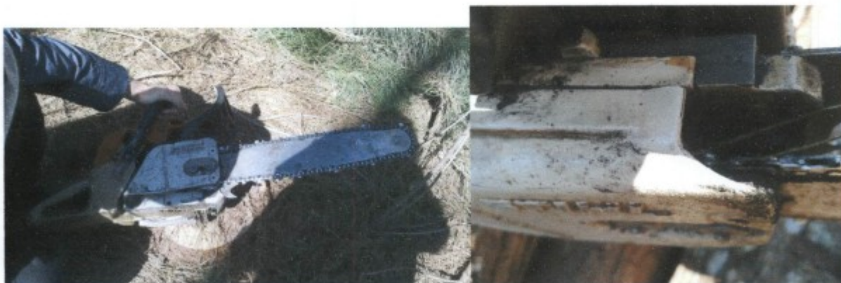
Momento da verificação dos itens obrigatórios de segurança na operação de motosserras, no detalhe a falta do pino pega corrente.
