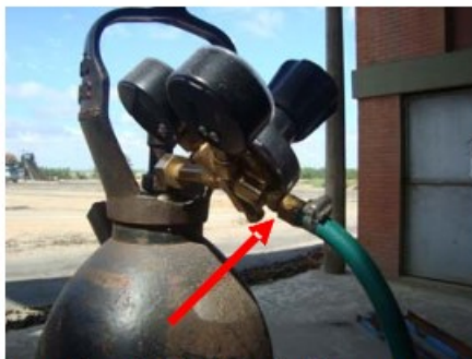
Os equipamentos de solda não atendiam a legislação, pois não apresentavam mecanismos contra retrocesso de chamas, na saída dos cilindros e chegada no maçarico.
