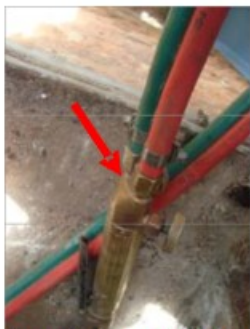
Os equipamentos de solda não atendiam a legislação, pois não apresentavam mecanismos contra retrocesso de chamas, na saída dos cilindros e chegada no maçarico.
