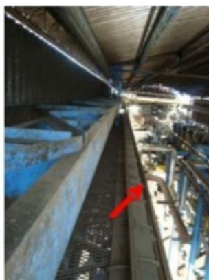
A direita e no centro: Locais da ponte rolante sem guarda-corpo, sem rodapé e com risco de esmagamento de trabalhadores. A esquerda: detalhe de escada, sem proteção, a ceca de 5 (cinco) metros de altura.
