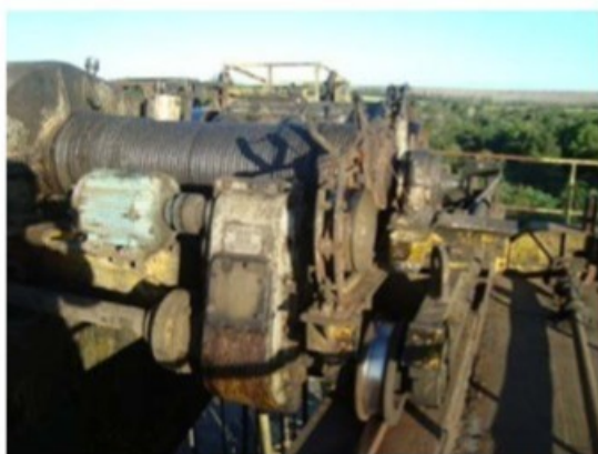
Detalhe a direita: Partes móveis sem proteção. A esquerda: Ponte rolante sem identificação de carga máxima.
