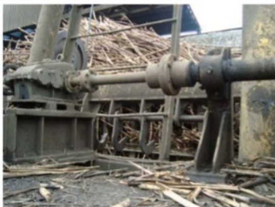
Detalhe a direita: Partes móveis sem proteção. A esquerda: Ponte rolante sem identificação de carga máxima.
