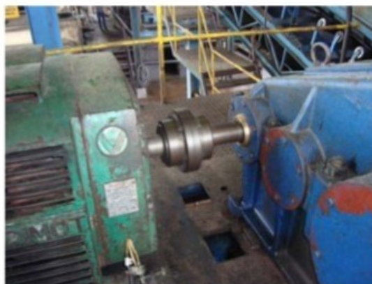
Detalhe a direita: Partes móveis sem proteção. A esquerda: Ponte rolante sem identificação de carga máxima.
