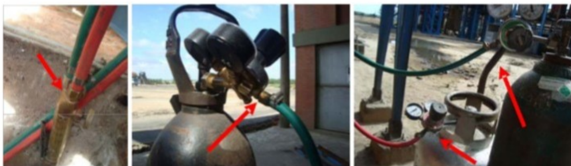
Os equipamentos de solda não atendiam a legislação, pois não apresentavam mecanismos contra retrocesso de chamas, na saída dos cilindros e chegada no maçarico.
