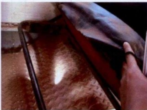
Detalhe de assentos soltos no ônibus Mercedes Benz LP 1113, placa [REDACTED]
