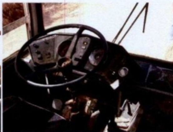
Painel sem velocímetro
