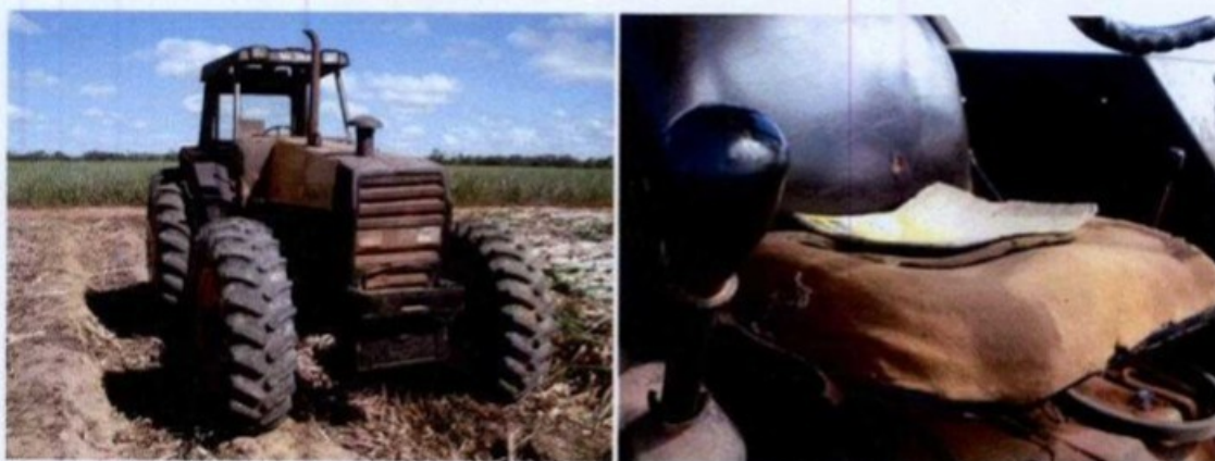
Trator encontrado na frente de plantio em precário estado de manutenção, inclusive sem sinal sono de ré.
