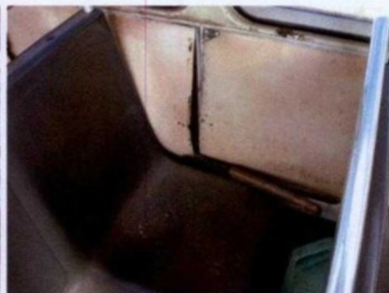
Revestimento interno solto com facão enfiado na fresta
