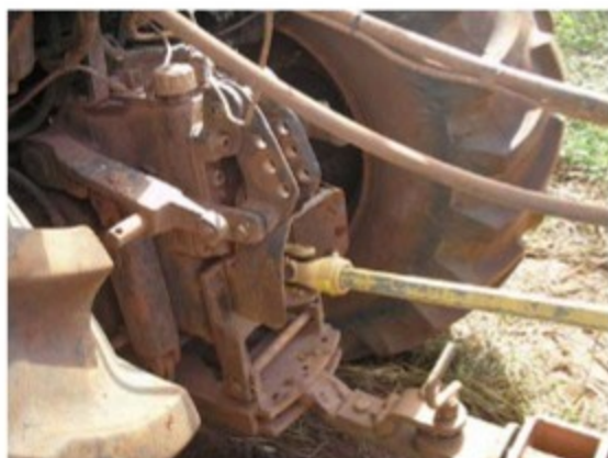
Articulações entre trator e caçamba para esparramação de calcário e gesso sem proteções.
