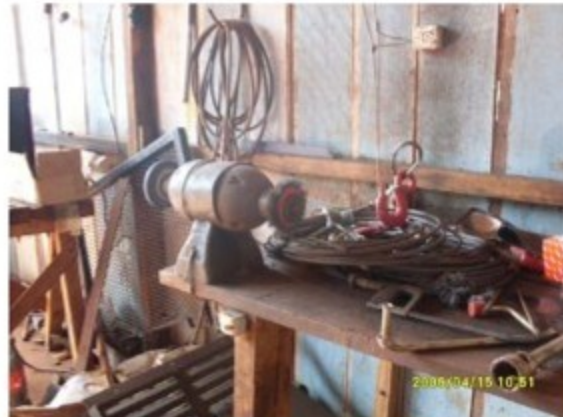
Máquina sem proteção.
