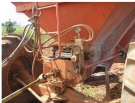
Articulações entre trator e caçamba para esparramação de calcário e gesso sem proteções.
