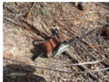
Equipamento sem dispositivo de segurança
