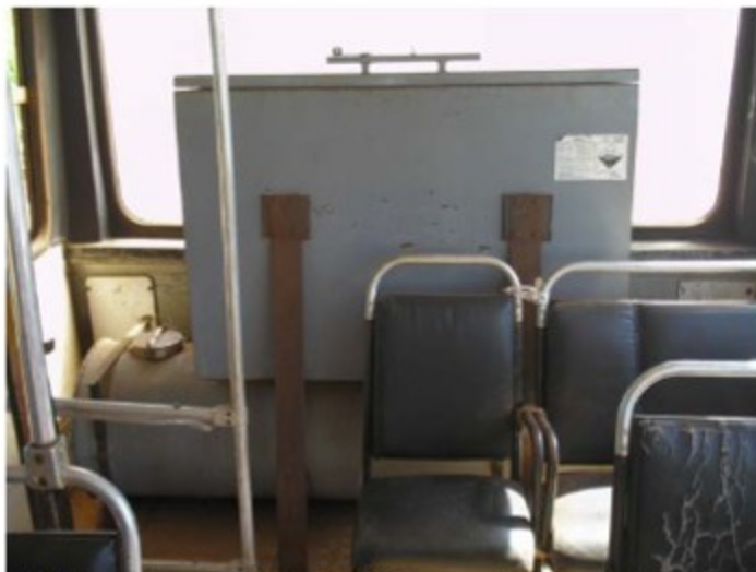
Vista aos fundos do ônibus de uma adaptação: Caixa para transporte de ferramentas e utensílios e em baixo o recipiente para armazenagem da água.
