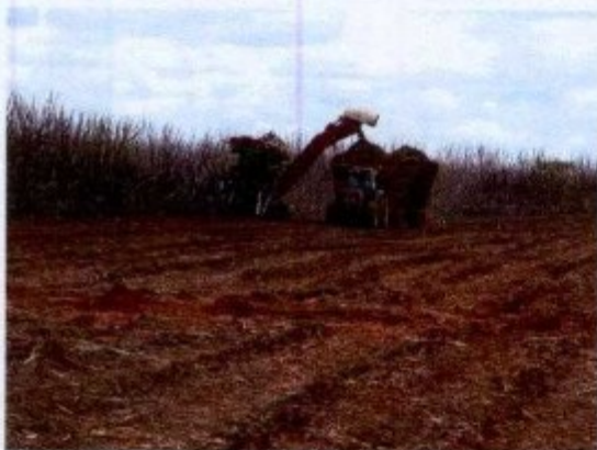
Para cada máquina colheitadeira são destacados dois tratores de transbordo, enquanto um está sendo carregado, o outro se desloca até o caminhão para descarregar.
