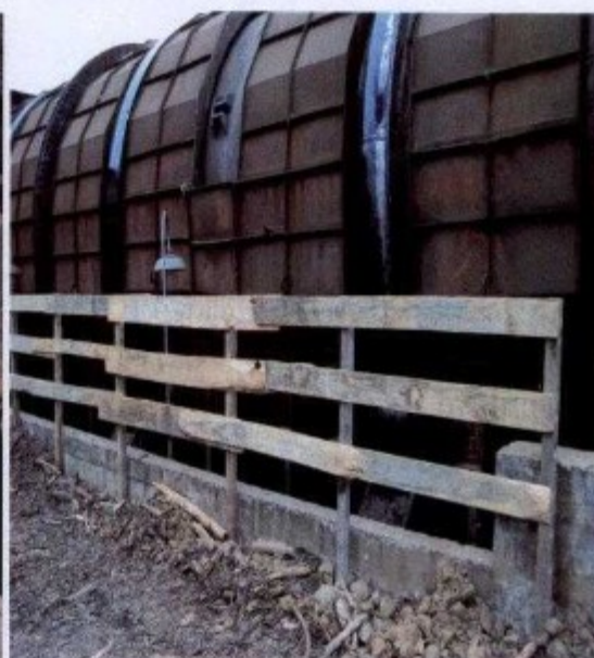
Proteção da área em desnível junto ao desfibrador
