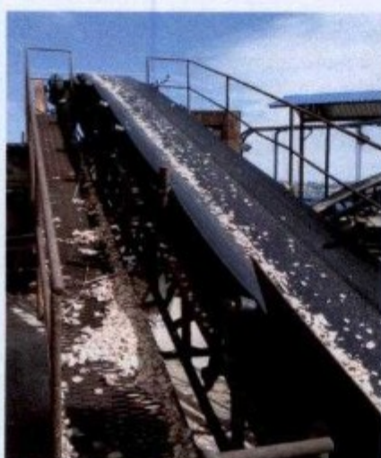
Colocação de proteções (guarda-corpo) na área da correia transportadora
