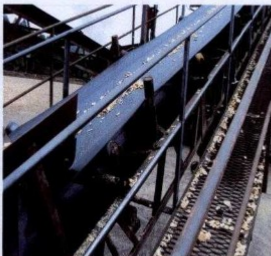
Colocação de proteções (guarda-corpo) na área da correia transportadora
