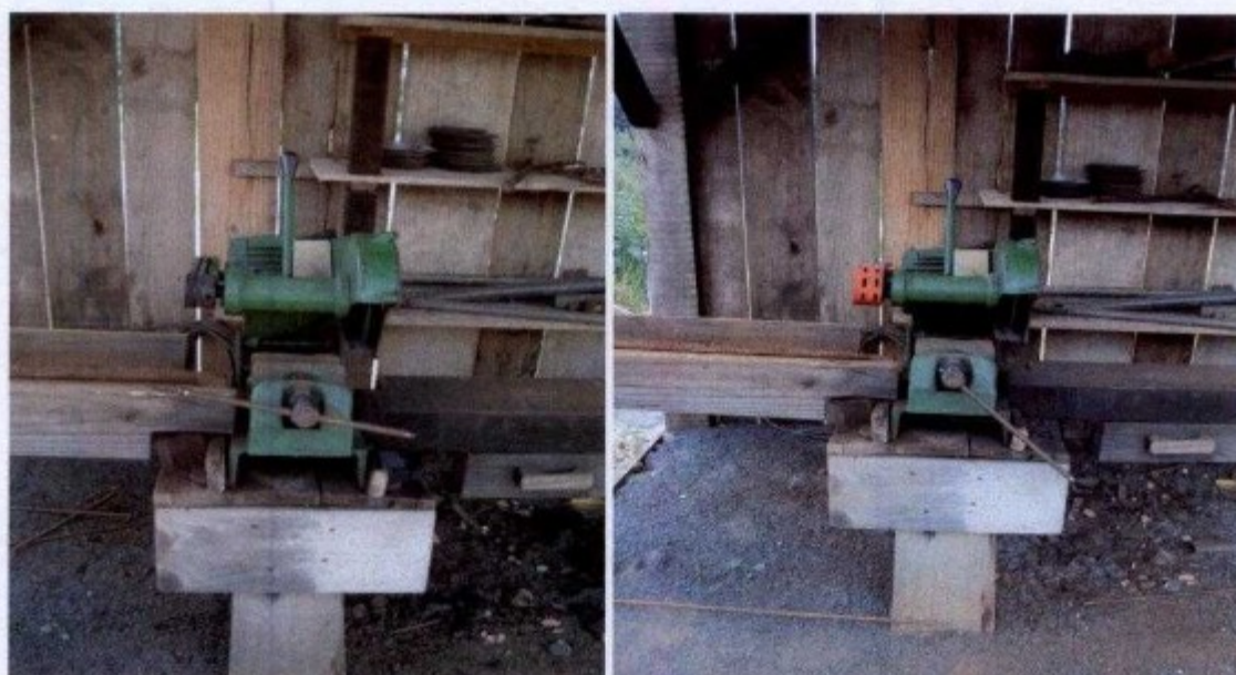
Proteção das transmissões de força do disco policorte
