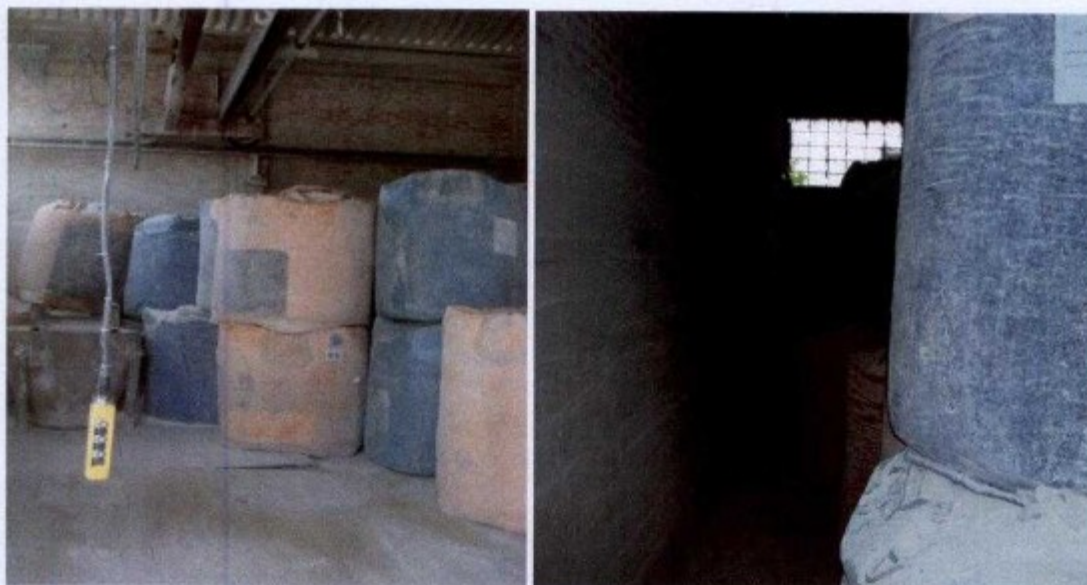
Armazenamento dos Big- Bags com o devido afastamento em relação às paredes da edificação
