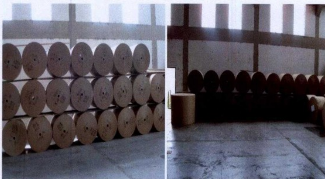
Adequação do empilhamento das bobinas de papel em relação às regras para trabalho em altura
