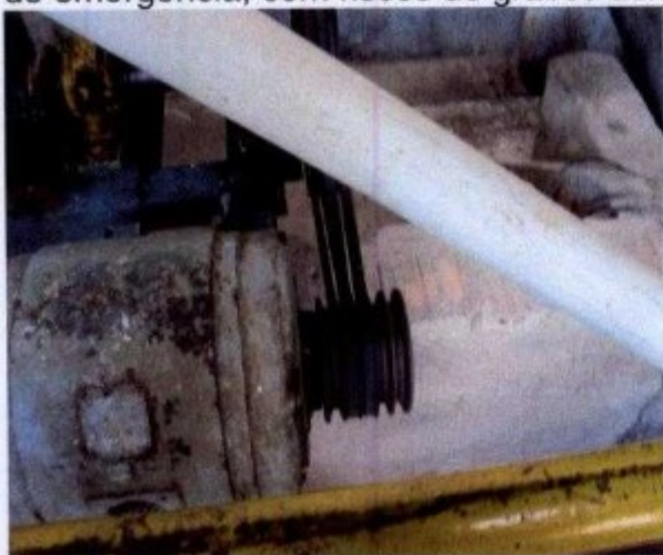
fotos: mesas com transmissão de força sem proteção e sem botão de parada de emergência
