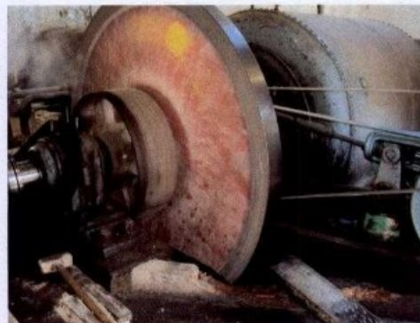
fotos: desfibradora sem proteção nas transmissões de força e sem botão de parada de emergência
