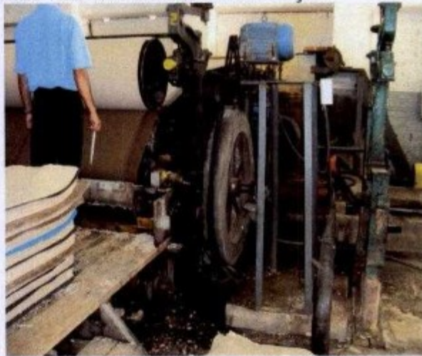
fotos: mesas com transmissão de força sem proteção e sem botão de parada de emergência
