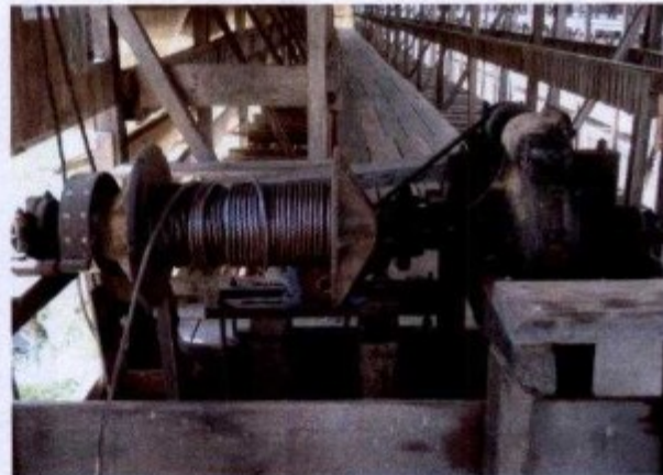
foto: guincho de arraste do carrinho com papelão, com transmissão desprotegida
