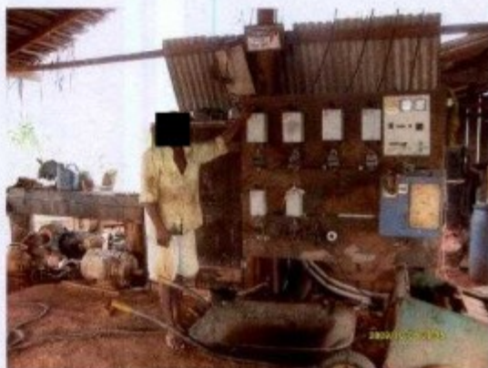
(esq.) Vista posterior do painel de acionamento dos moinhos, distante das máquinas. (dir.) Único dispositivo de acionamento dos moinhos.
