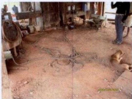
Fios energizados no chão e em ligações improvisadas no britador (dir).
