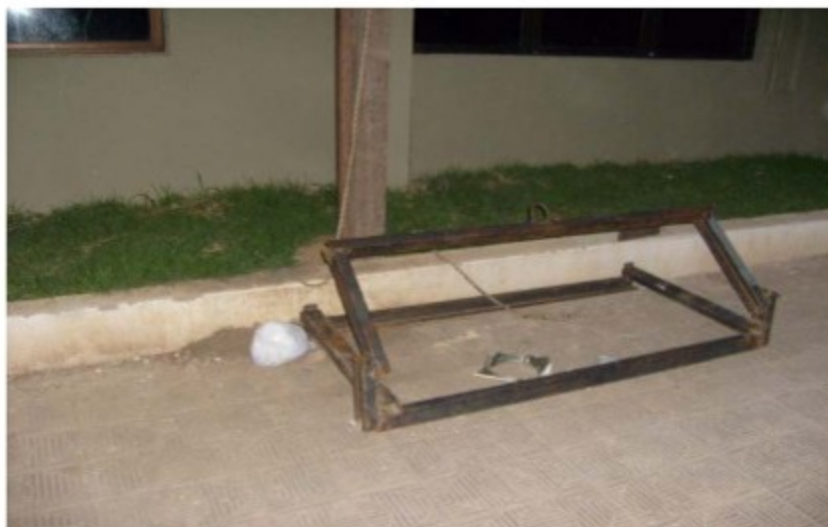
Foto 7: Peça de aço para içar telhas.
