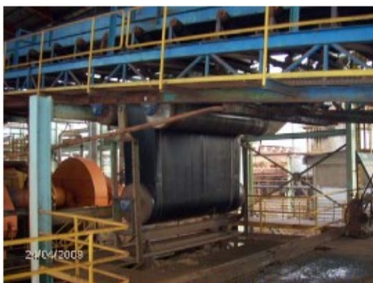
Detalhe da ausência de sinalização no piso das áreas de risco. À direita: correia transportadora. À esquerda: hilo da moenda.
