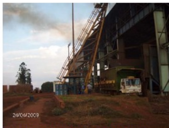
Detalhe da ausência de sinalização no piso das áreas de risco. À direita: correia transportadora. À esquerda: hilo da moenda.
