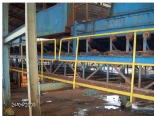
Detalhe da correia transportadora da moenda, cujos roletes se apresentavam sem qualquer proteção que impedisse o contato com trabalhadores
