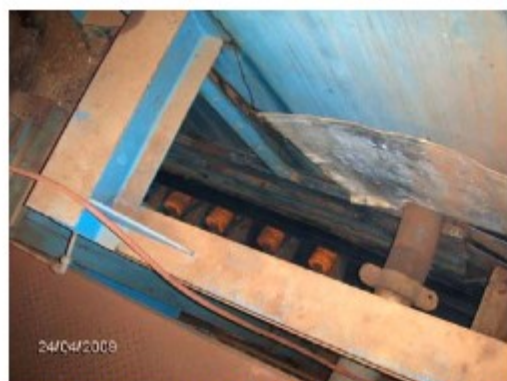
Detalhe da parte superior da moenda que mostra a ausência de proteções nos vãos que evitassem, por exemplo, a queda de trabalhadores
