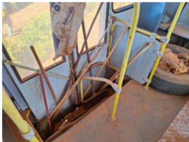
A alínea “d” do item 31.9.1 da NR-31 determina que o transporte coletivo de trabalhadores deve possuir compartimento resistente e fixo, separado dos passageiros, onde devem ser transportadas as ferramentas e materiais que acarretem riscos à saúde e à segurança do trabalhador, com exceção dos objetos de uso pessoal, o que não foi observado pelo empregador.
