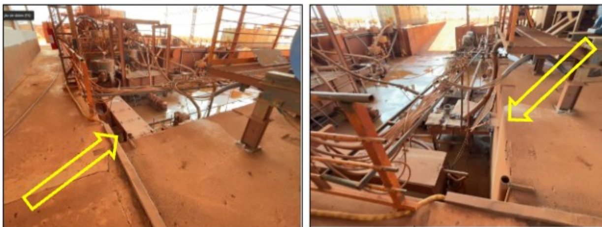
Imagens acima: Abertura no piso superior do pátio de máquinas, que acarretava possibilidade de queda de trabalhadores.
