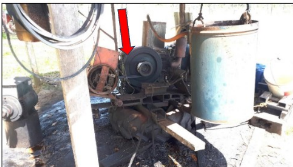
Imagens acima: Superior, betoneira sem proteção do conjunto pinhão-cremalheira. Inferior, moto-gerador diesel sem proteção do conjunto polias-correias.
