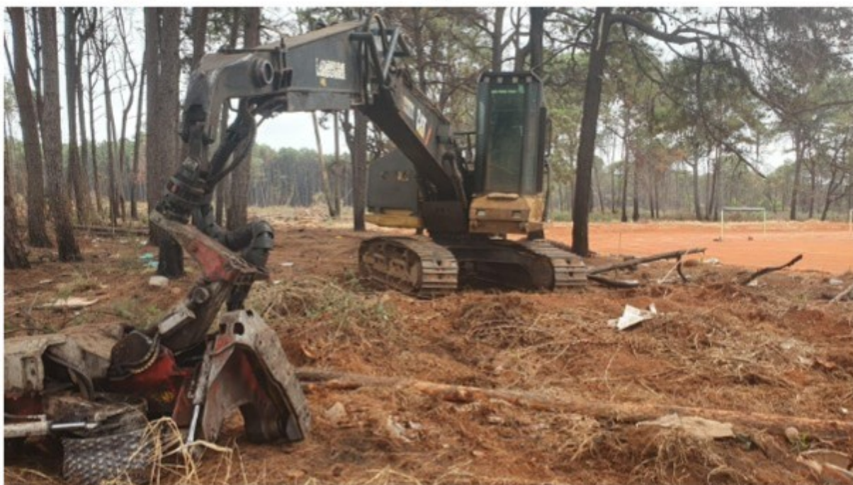
Foto 03 – Equipamento “Harvester” utilizado para o corte de pinus.
