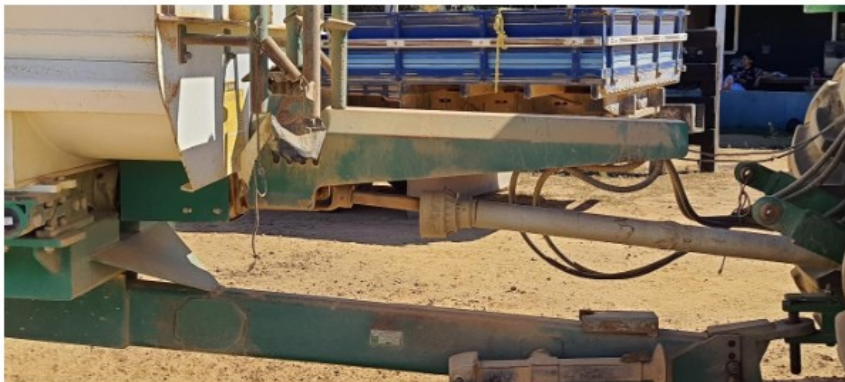
Foto 3: proteção do cardã existente entre o trator e o vagão forrageiro sem estar fixada no acoplamento do vagão.
