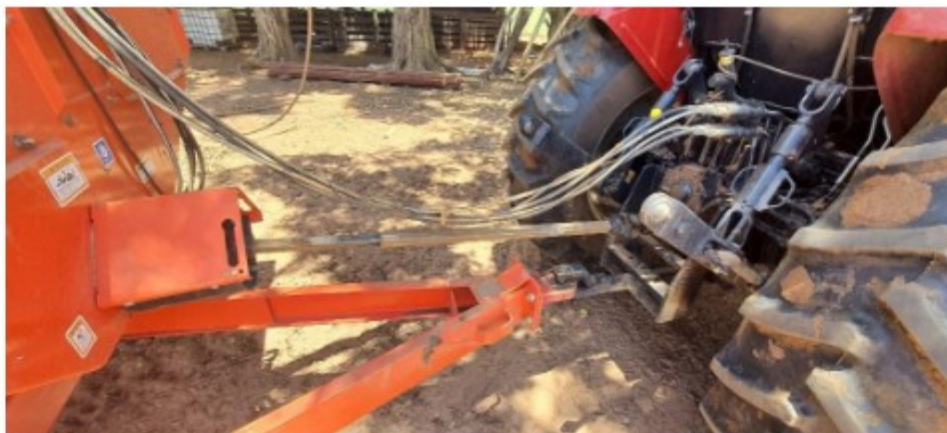
Foto 11: cardã sem nenhuma proteção existente entre um trator e um vagão misturador que era operado por um trabalhador sem capacitação
