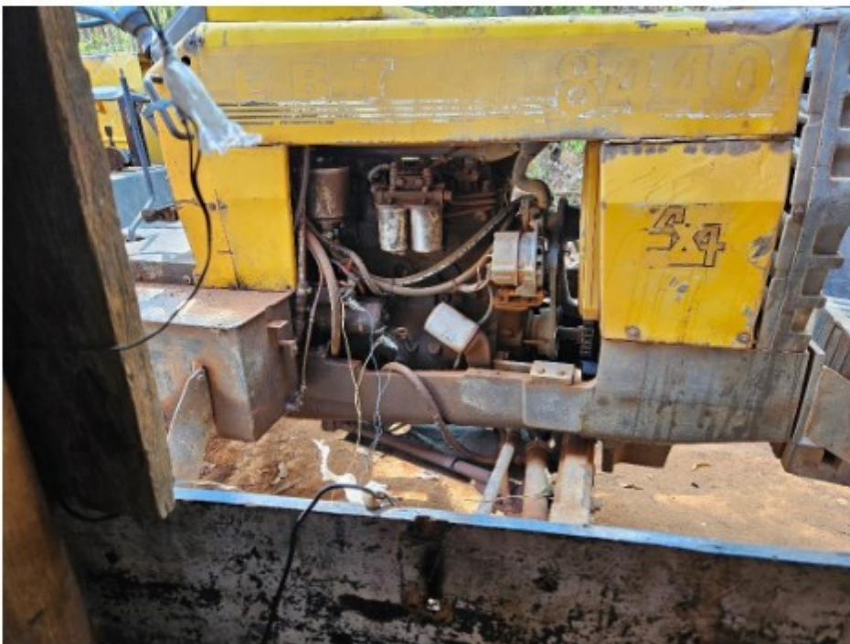
Imagem 16. Instalações elétricas improvisadas conectadas à bateria do trator. Fotografia capturada em 09/09/2024.
