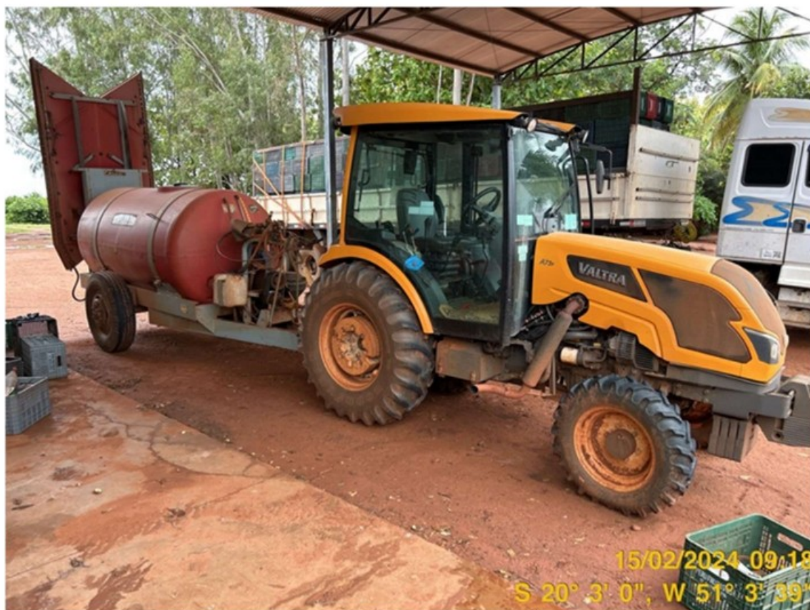
Foto 34: Implemento agrícola acoplado a um trator com eixo cardã sem proteção
