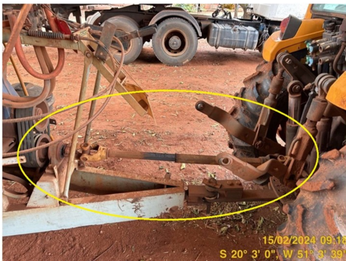
Foto 35: Implemento agrícola acoplado a um trator com eixo cardã sem proteção. (detalhe)
