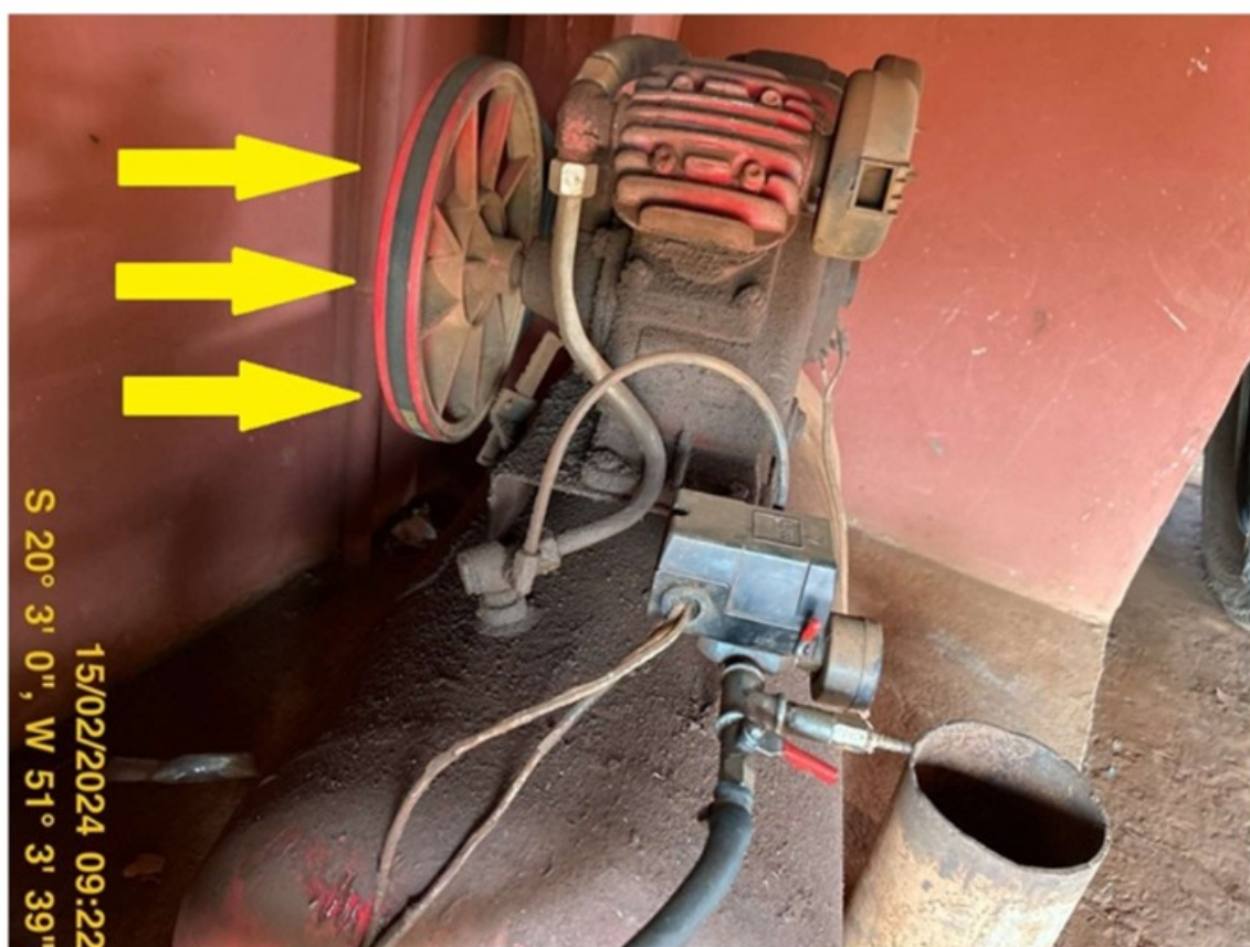
Foto 28: Transmissões de força sem proteção
