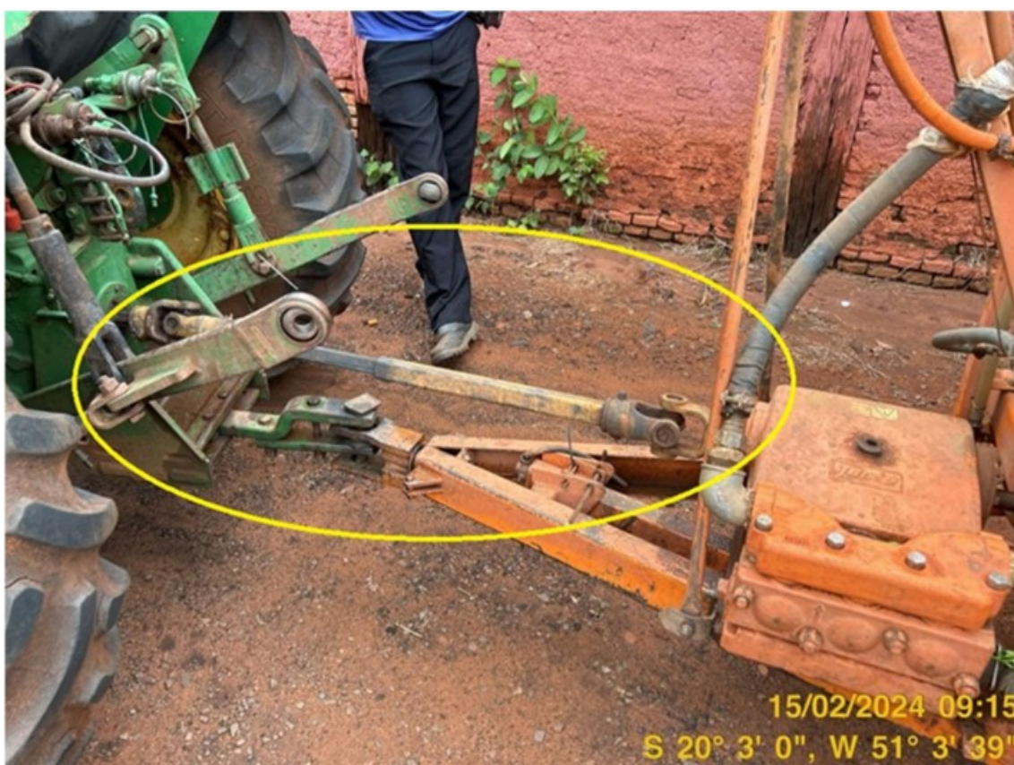
Foto 33: Implemento agrícola acoplado a um trator com eixo cardã sem proteção. (detalhe)
