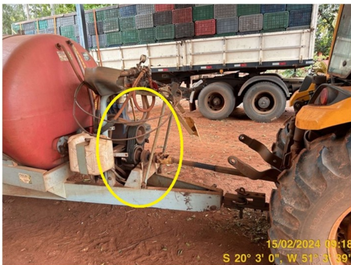
Foto 30: Transmissões de força sem proteção
