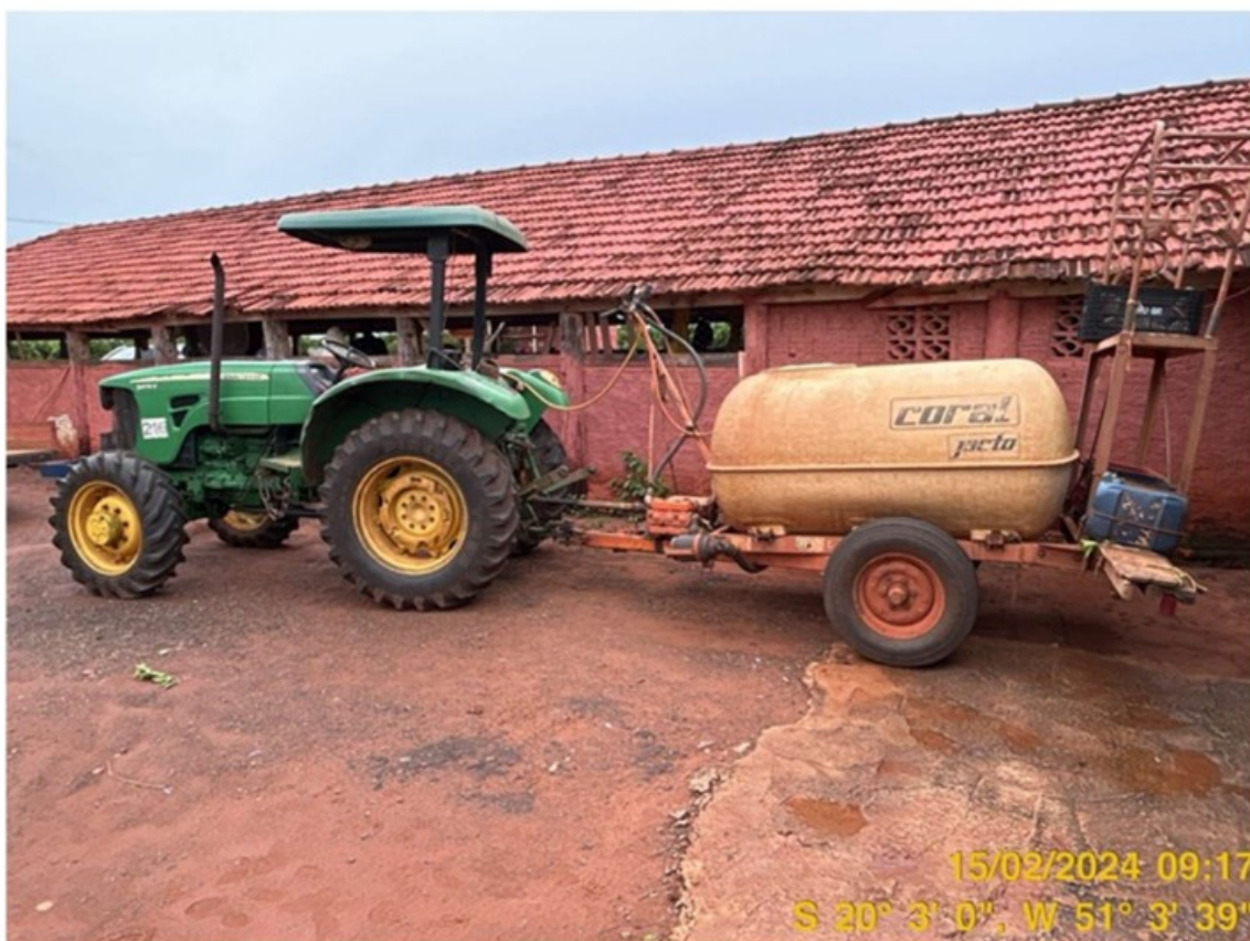
Foto 32: Implemento agrícola acoplado a um trator com eixo cardã sem proteção
