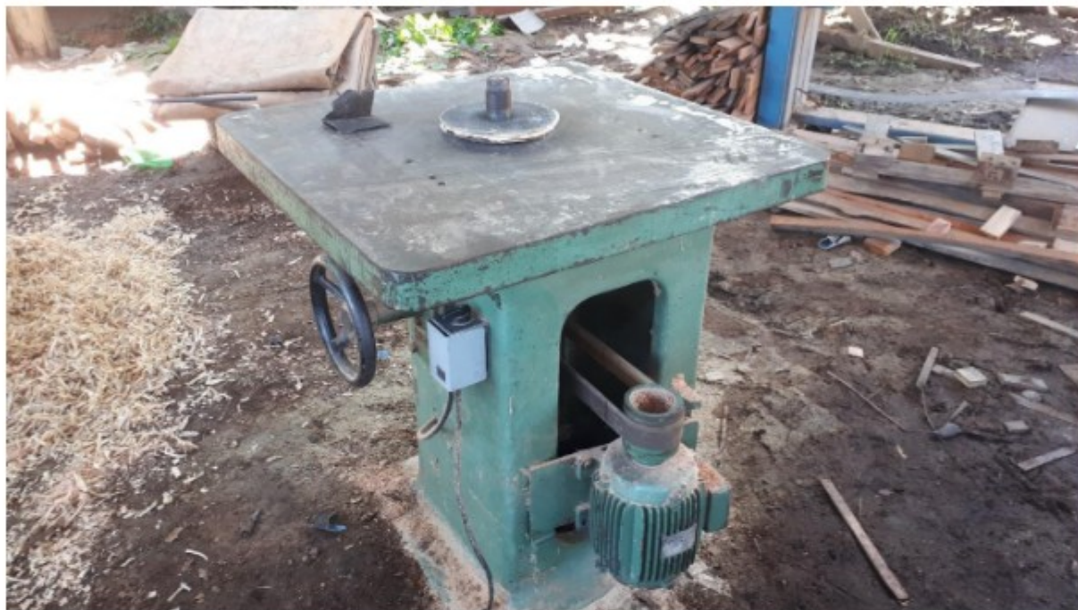
Imagens acima: exemplos de máquinas sem sistemas de proteção em zonas de perigo.
