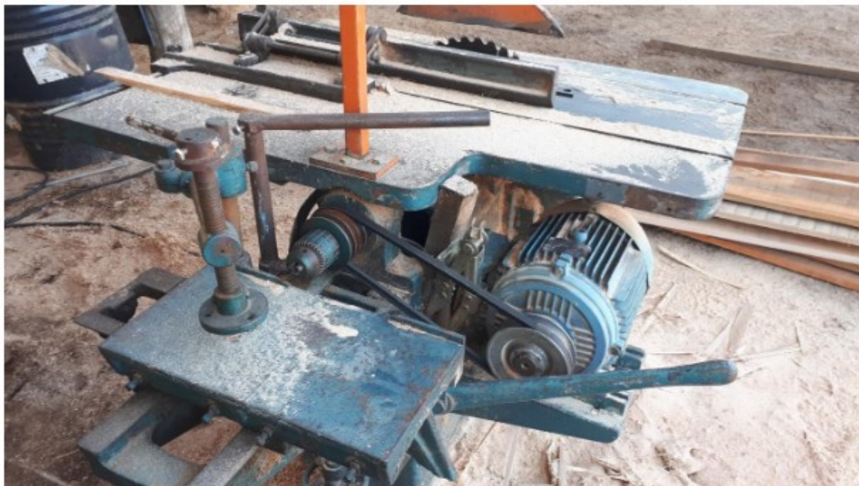
Imagens acima: exemplos de máquinas sem proteção das transmissões de força.
