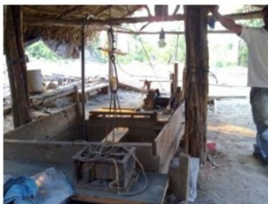
“Cavalo” utilizado improvisadamente pelos trabalhadores para o transporte até o interior do poço.
