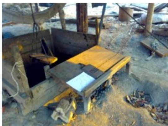
Equipamento improvisado para realizar o transporte de trabalhadores até o interior da mina.
