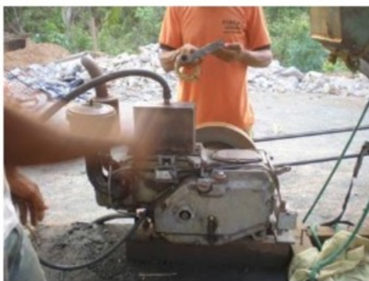
Partes móveis do maquinário sem qualquer proteção.
