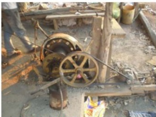
Partes móveis do maquinário sem qualquer proteção.
