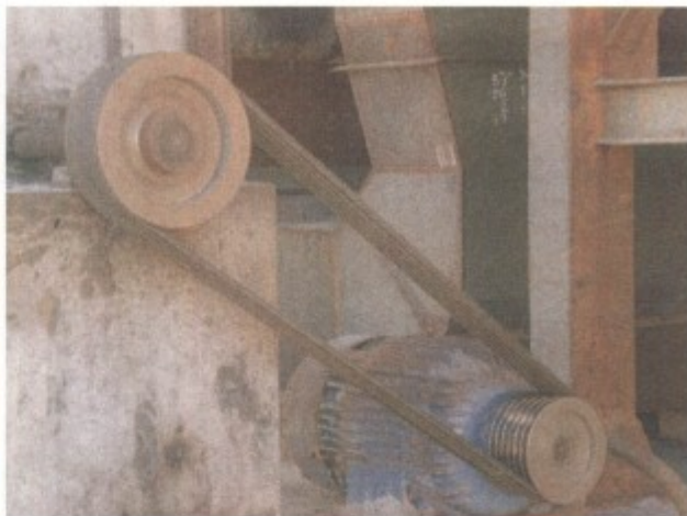
Fotos 09 e 10 – transmissões de força de máquinas sem proteção.
