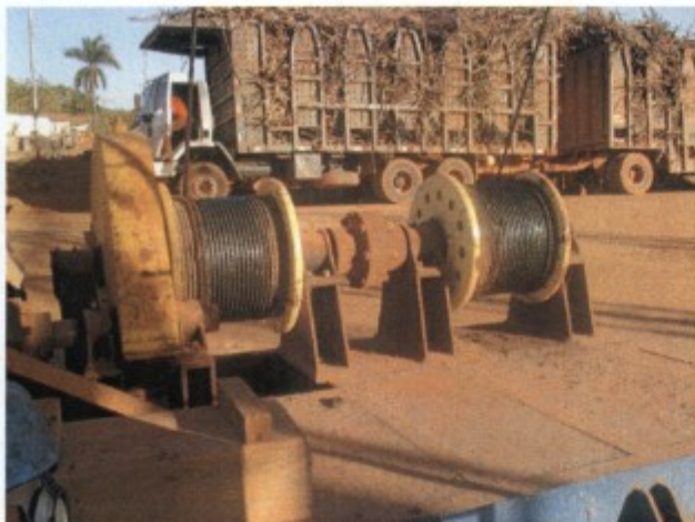
Fotos 09 e 10 – transmissões de força de máquinas sem proteção.
