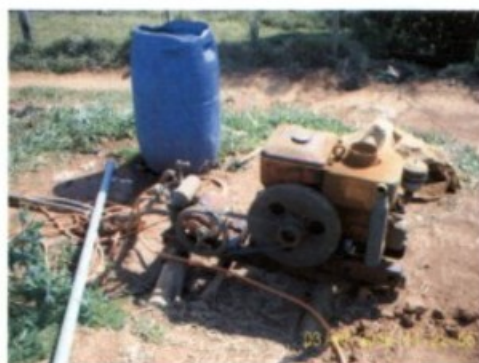
Locais de preparo de agrotóxicos, com motores a combustão, cujas transmissões de força encontravam-se sem qualquer dispositivo de proteção.
