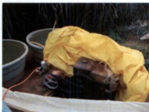
Locais de preparo de agrotóxicos, com motores a combustão, cujas transmissões de força encontravam-se sem qualquer dispositivo de proteção.
